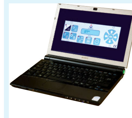
Les panneaux électriques peuvent être contrôlés par un PC via une connexion RS 485.
