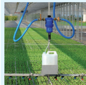
Système de dosage proportionnel fixé sur la chariot d'arrosage. Une solution idéale pour la pulvérisation de pesticides.
